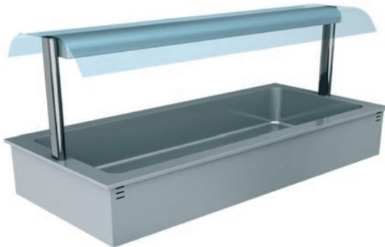
Vasca bagnomaria da incasso, con sovrastruttura. Realizzata in acciaio inox AISI 304. Ideale per esporre pietanze in contenitori. Regolazione della temperatura da +30°C ÷ +80°C tramite termostato. Vasca raggiata e stampata, profondità h. 215 mm. Mantenimento automatico del livello dell'acqua. Sovrastruttura realizzata con vetro temperato. Illuminazione con lampade alogene. Può essere accessoriata con vetro frontale parasputi. Disponibile nelle dimensioni 2-3-4-5-6 GN.
